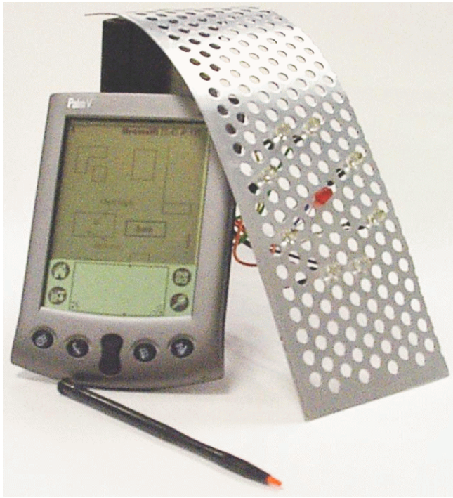
Abb. 2. Leistungsstarke Infrarotsender bilden die Grundlage IRREAL Systems
